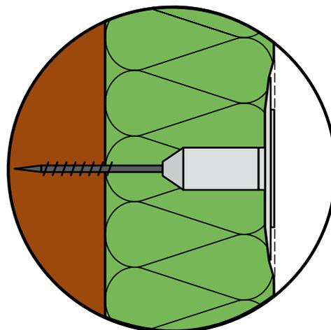
Lors de leur mise en place, **la rondelle en plastique doit obligatoirement être affleurée à la surface du panneau.**
