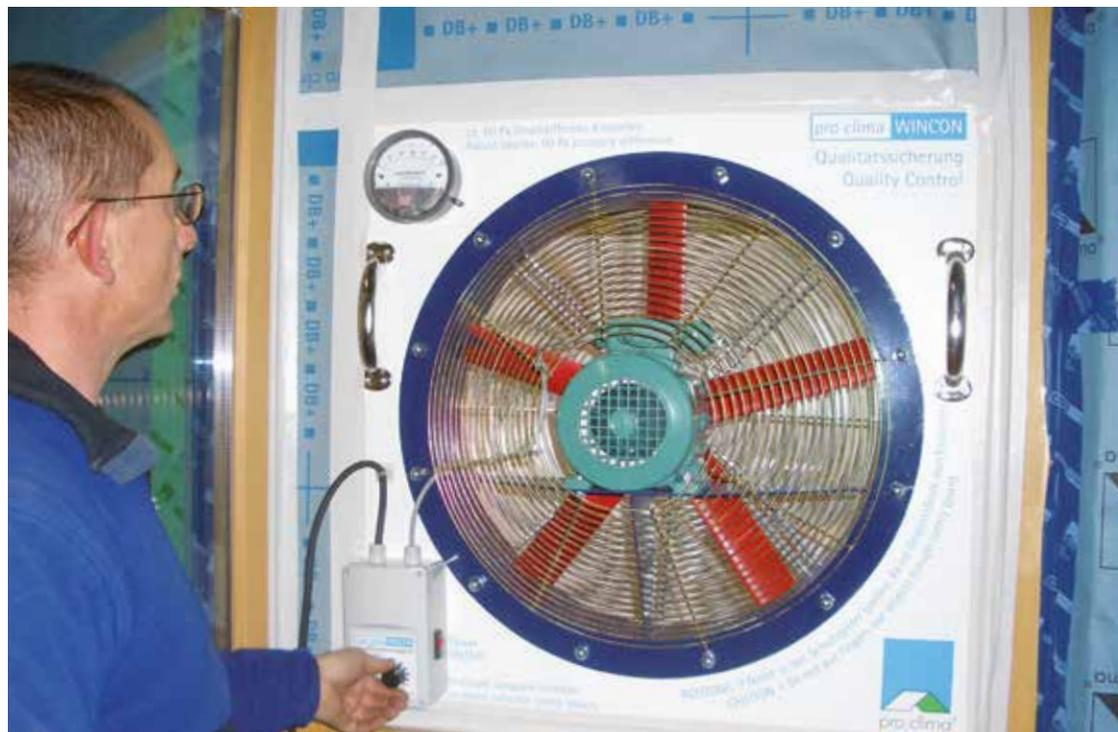
Le ventilateur de contrôle WINCON est monté dans une fenêtre ou une porte. La dépression créée dans le bâtiment aide à détecter les défauts d'étanchéité éventuels.
