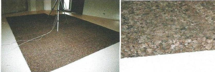
Temps de réverbération moyen (T1 - salle vide; T2 - salle occupée avec l'éprouvette):
