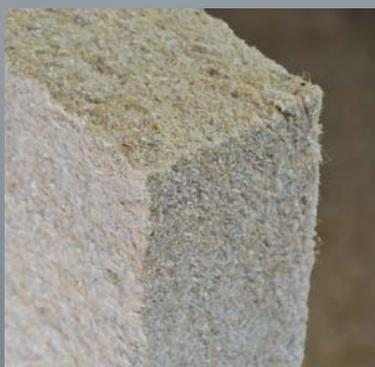
Biofib'ouate est un isolant biosourcé composé de ouate de cellulose (60 %) et de fibres de chanvre (25 %) qui permettent une bonne tenue mécanique et une certaine flexibilité des panneaux (pose facilitée entre montants sans déchirure).
